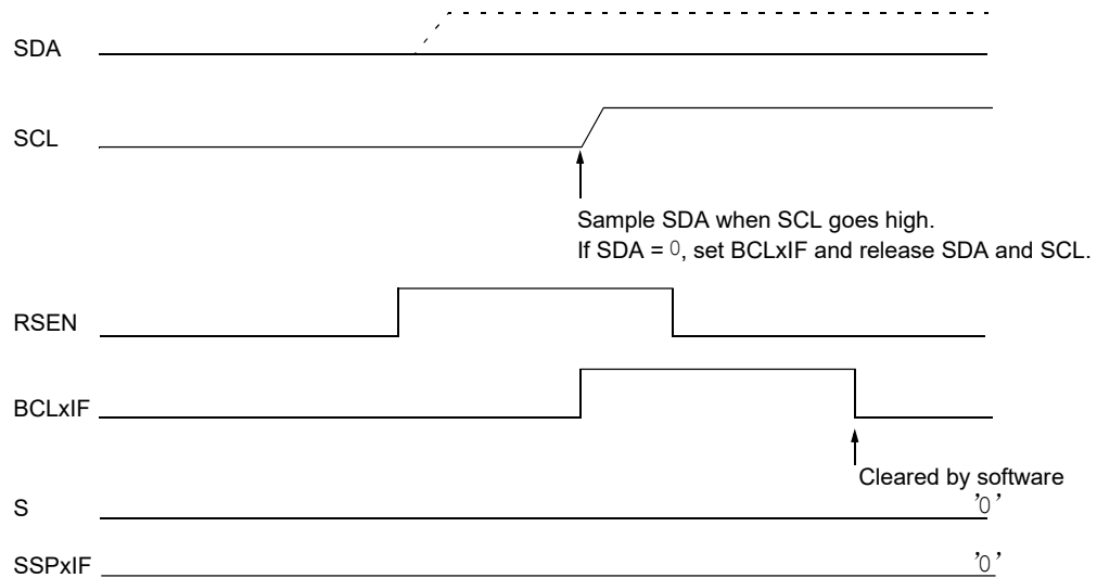
图 22-37. 重复启动条件期间的总线冲突（情形 1）
