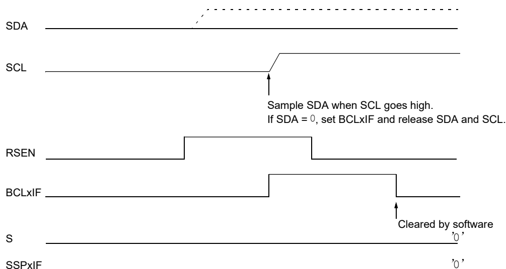
图 30-37. 重复启动条件期间的总线冲突（情形 1）
